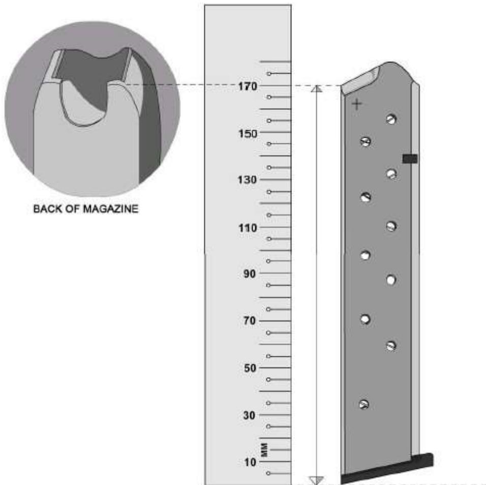
Zásobník je umístěn svisle vzpřímeně na rovný povrch, přičemž je změřen od tohoto povrchu k zadní části podávacích výstupků zásobníku, jak je znázorněno. Jsou povoleny pouze přímé (rovné), pevné (ne odpružené/stlačitelné botky) zásobníky (tj. ohebné (flexibilní), bubnové, J, L, T zásobníky jsou zakázány).
